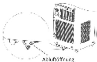
Vergewissern Sie sich im Falle des Kühlbetriebs, dass der Gummiverschluss, der die Abluftöffnung auf der Rückseite verschließt, korrekt positioniert ist. Zum Leeren des Behälters muss die Klimaanlage ausgeschaltet und der Netzstecker gezogen werden. Den Deckel von der hinteren Seite entfernen und das Ende über einem normalen Wasserabfluss positionieren.
